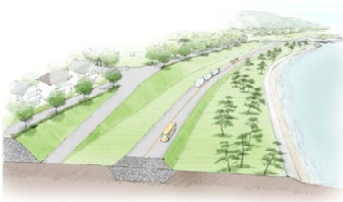
図1 盛土による防潮機能を有した道路
